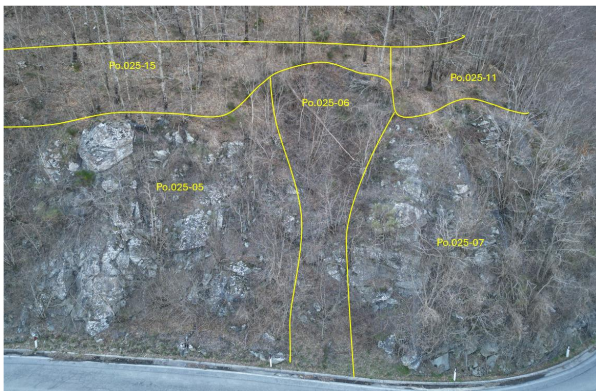
Figura 9-7: Ripresa aerea frontale della porzione immediatamente a sud della curva principale della scarpata oggetto di intervento. Sono tracciati i limiti degli interventi individuabili in Figura 9-2. Si noti il grosso volume isolato ( >5 \text{ m}^3 ) presente in testa allo sperone roccioso posto al centro dell'intervento Po.025-05 del quale viene fornita una vista dal basso in Figura 9-9.
