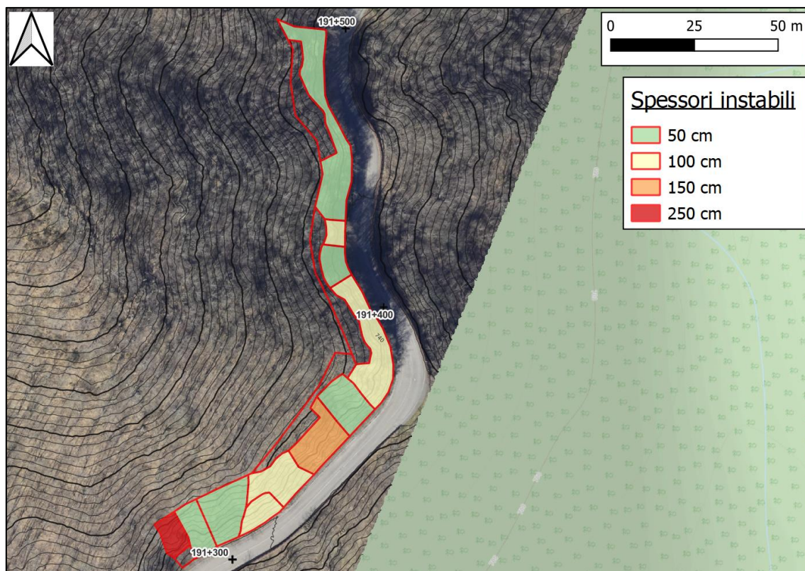
Figura 9-3: Individuazione degli spessori di ammasso superficiale instabile per ciascun settore in cui si è suddivisa la scarpata.
