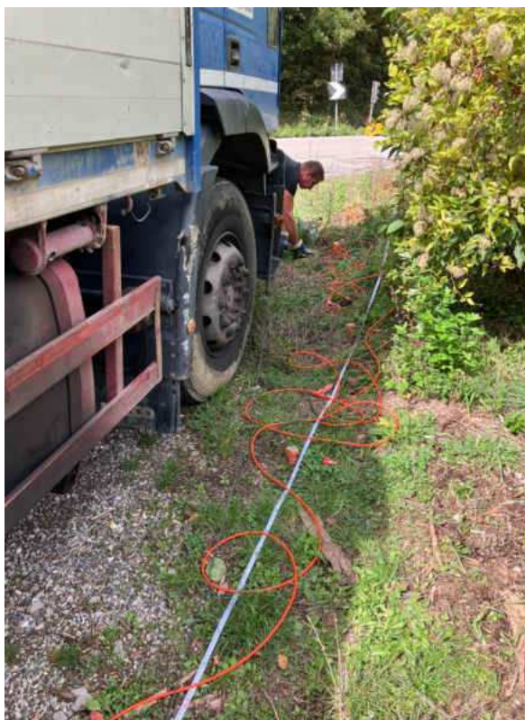
Figura 5: Stendimento sismico per tomografia sismica a rifrazione in Vp.
