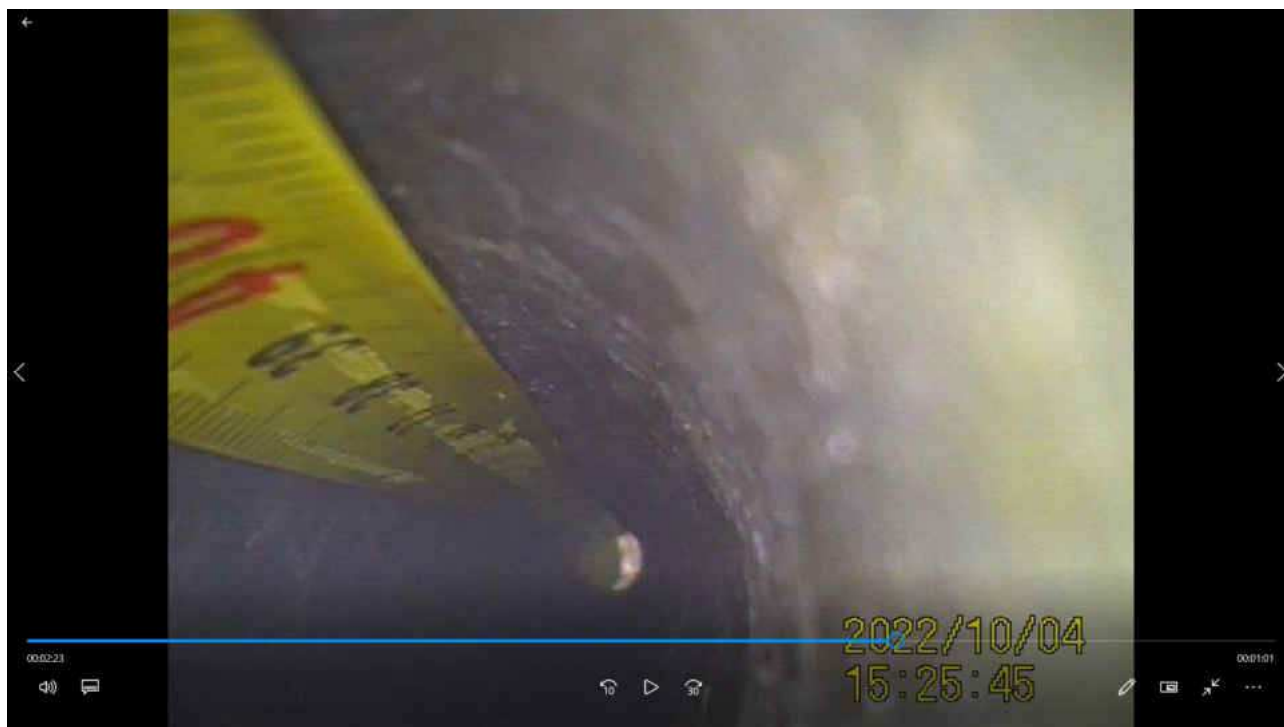
Figura 32. Probabile presenza di conglomerato cementizio a 40cm da fondo foro.
