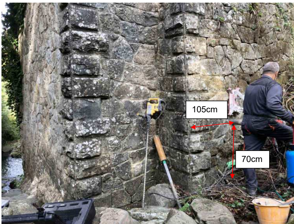
Figura 24.Esecuzione carotaggio C1.
