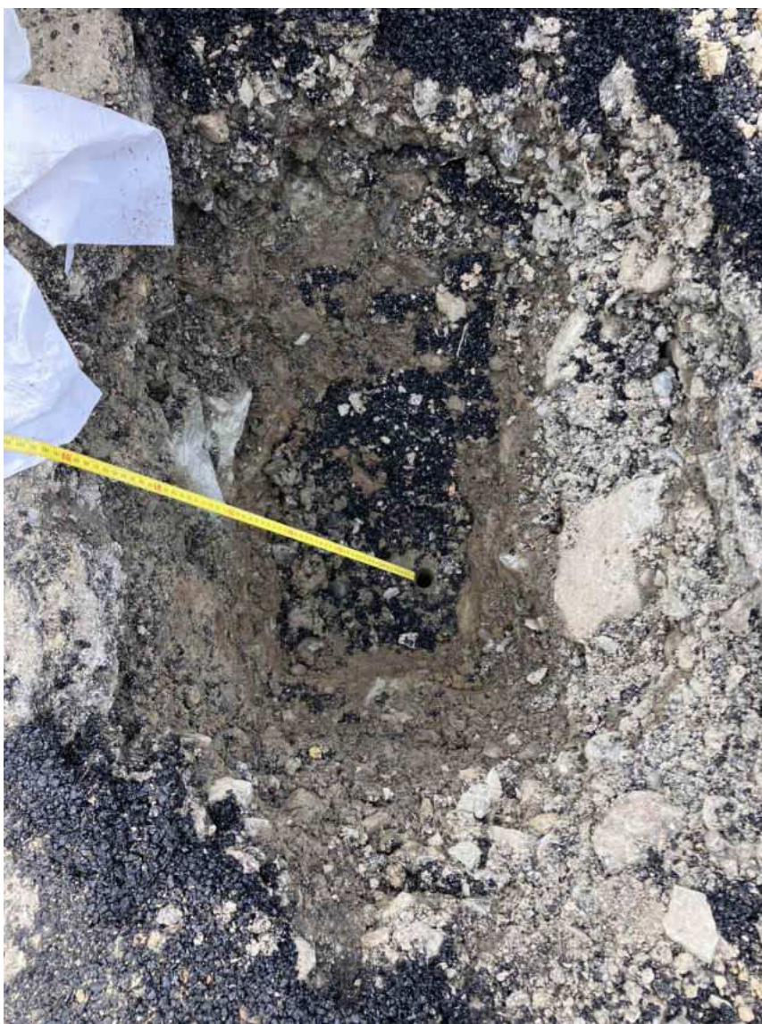
Figura 28.Scavo e foro per endoscopia, profondità totale m 1.90.
