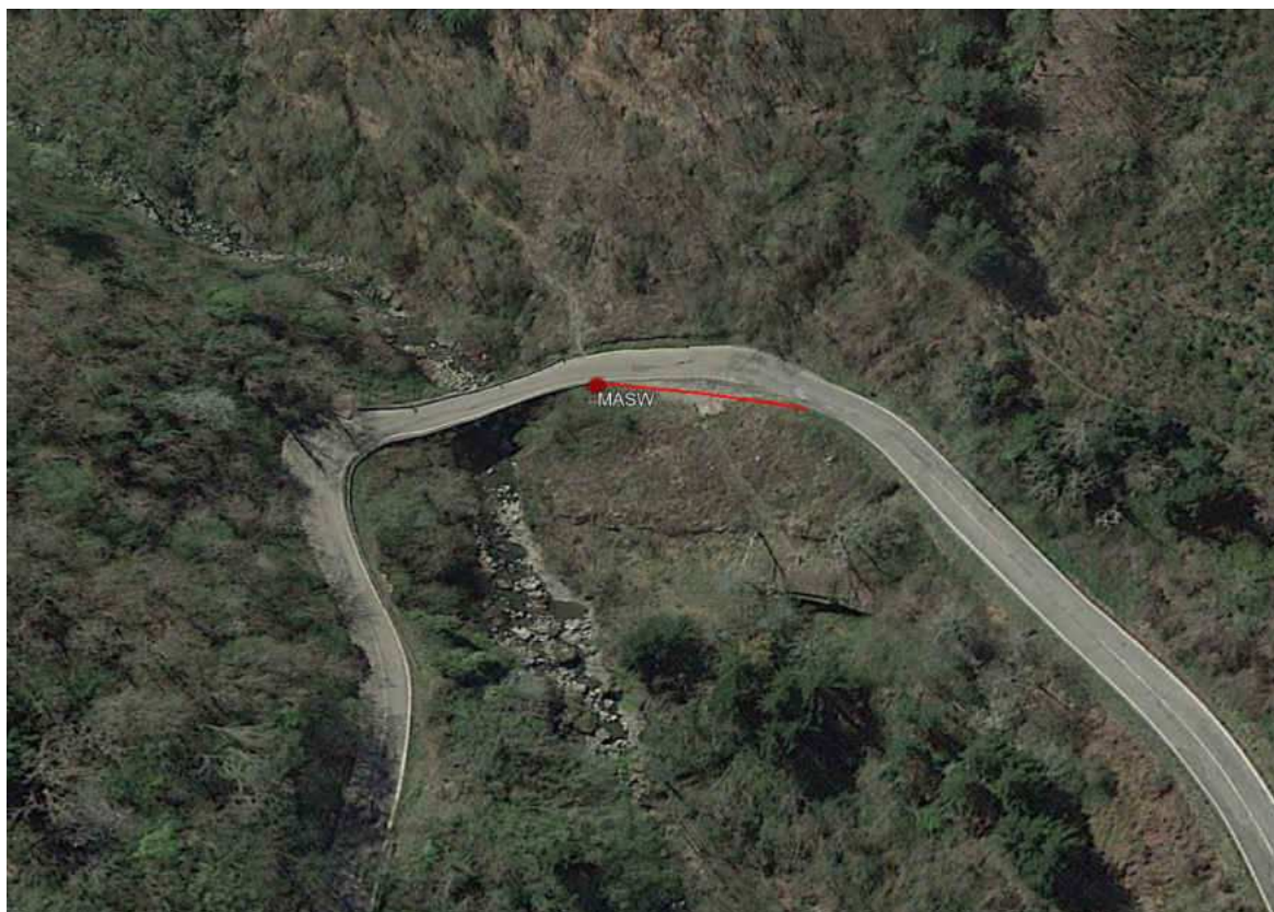
Figura 1: Stendimento linea sismica per l'acquisizione della MASW.
