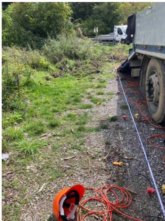
Figura 2: Stendimento linea sismica per l'acquisizione della MASW con geofoni verticali e orizzontali.
