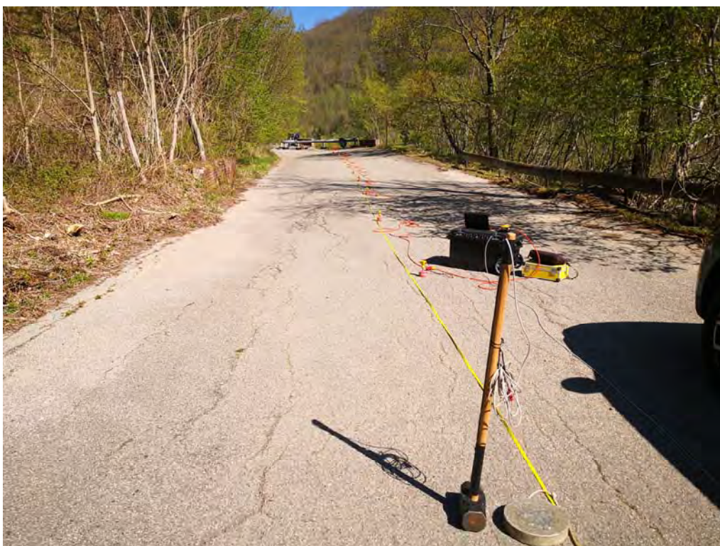
Foto n.2 : stendimento sismico di tipo M.A.S.W n.11.
