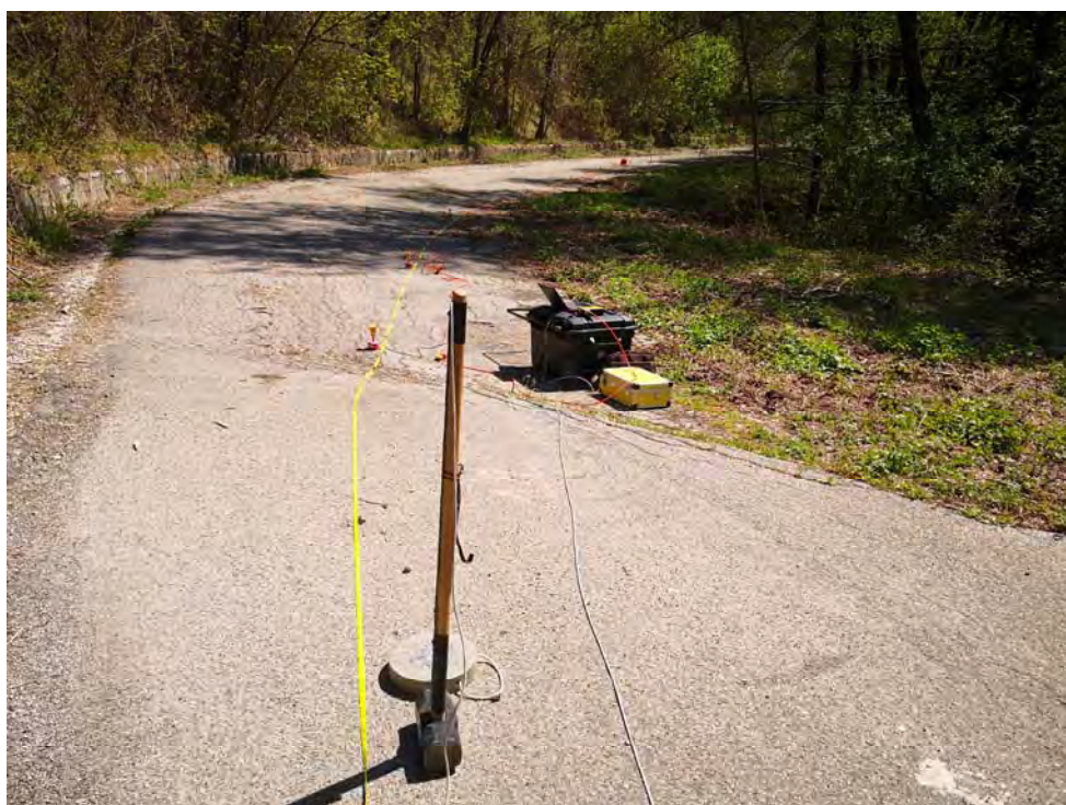
Foto n.5 : stendimento sismico di tipo M.A.S.W n.08.
