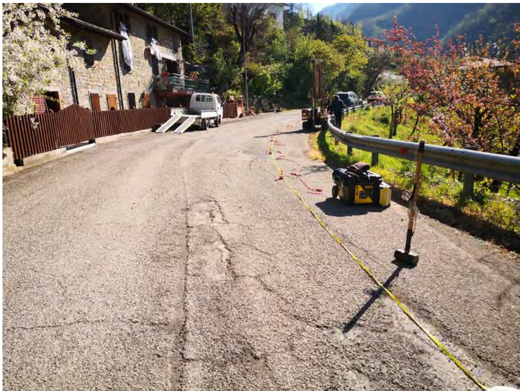
Foto n.1 : stendimento sismico di tipo M.A.S.W n.12.
