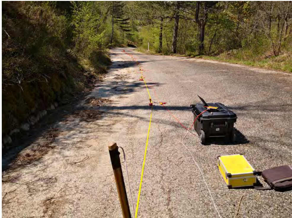
Foto n.7 : stendimento sismico di tipo M.A.S.W n.06.
