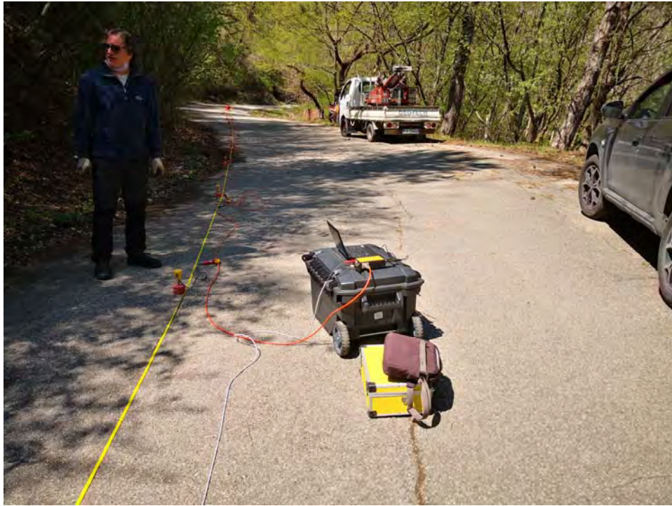
Foto n.6 : stendimento sismico di tipo M.A.S.W n.07.
