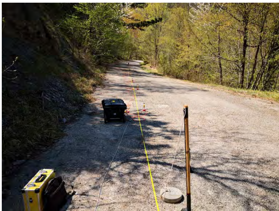
Foto n.8 : stendimento sismico di tipo M.A.S.W n.05.
