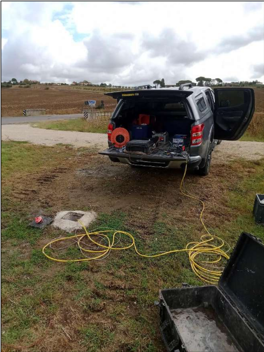
Fase preparatoria all'esecuzione dell'indagine sismica Down Hole
