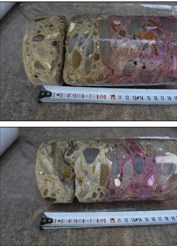
Misure dello strato di calcestruzzo carbonatato.
