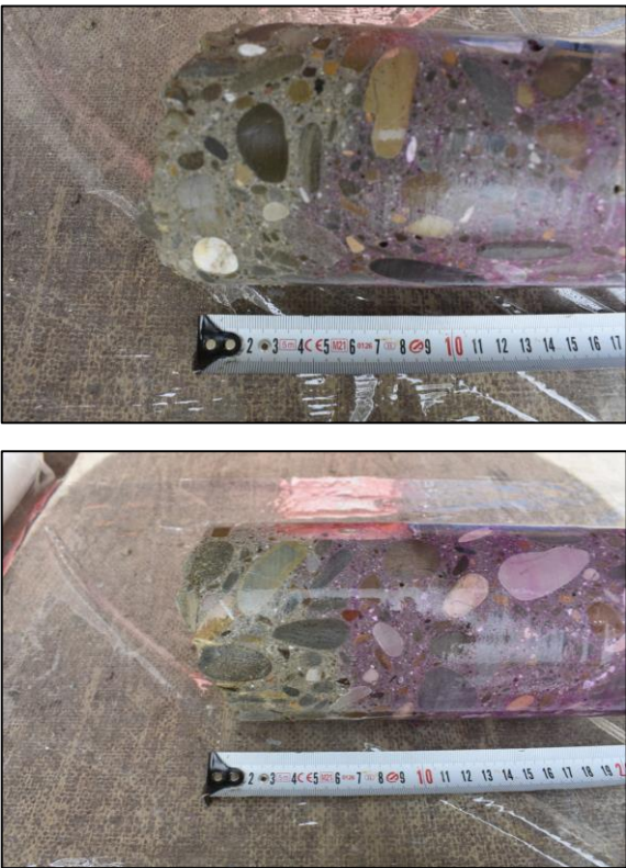
Misure dello strato di calcestruzzo carbonatato.
