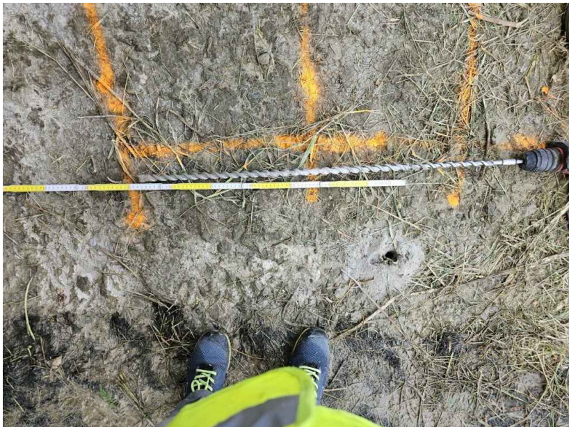
la fine della fondazione in calcestruzzo armato è stata rilevata a 68 cm da inizio foro
