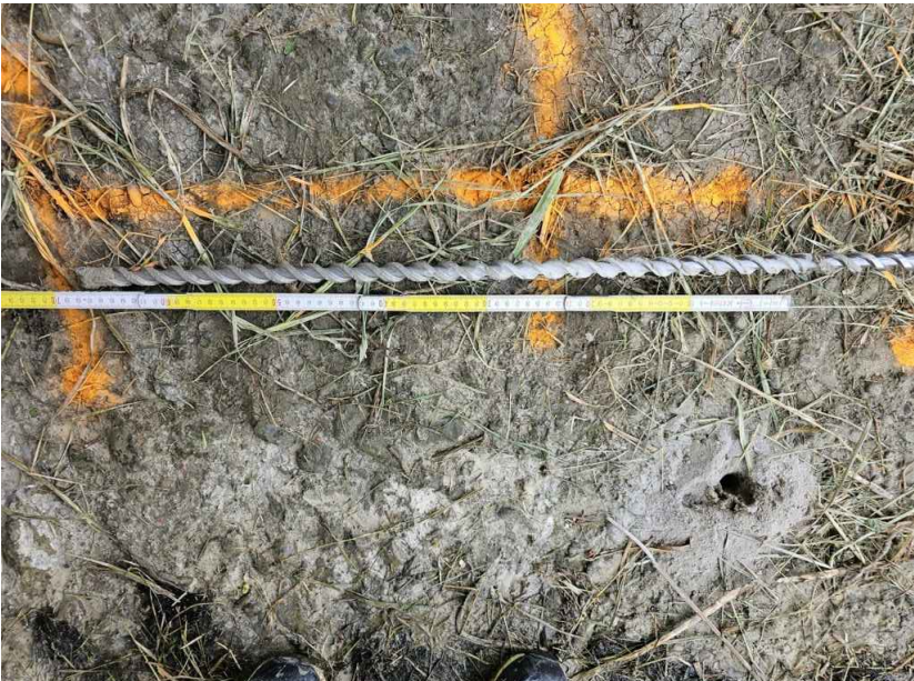
la fine della fondazione in calcestruzzo armato è stata rilevata a 68 cm da inizio foro
