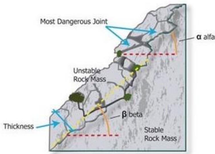
Figura 5-1. Schematizzazione della porzione corticale instabile.
