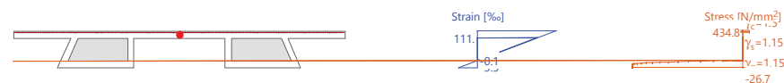
Figura 16. Verifica sezionale dell'impalcato della campata principale nella zona di appoggio con la pila principale
