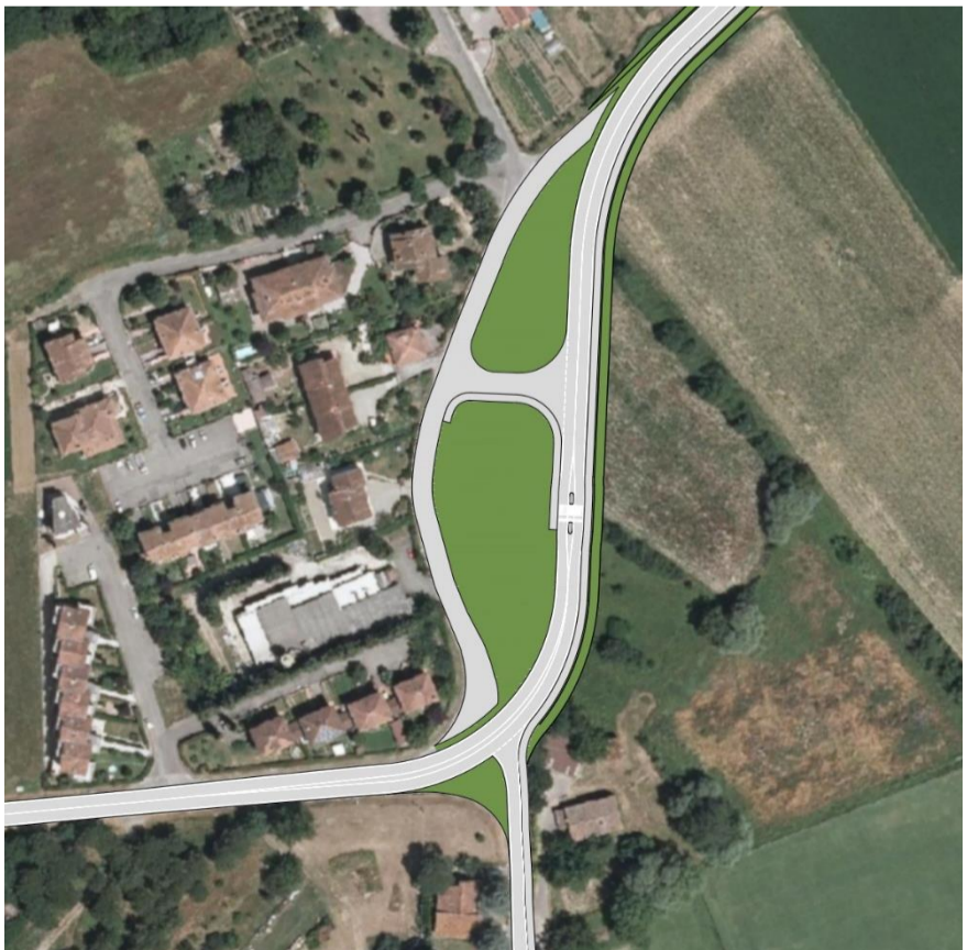
Figura 6 – Intersezione a precedenza nel nodo a Ponte a Buriano con rettifica del tracciato – alternativa progettuale
