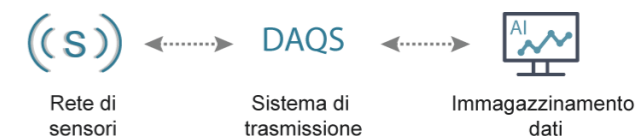
Figura 18 - Funzionamento dei sistemi di monitoraggio
