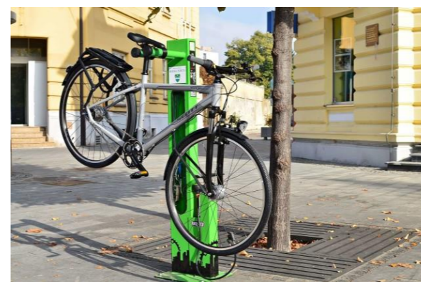
Figura 32 – Colonnina attrezzata per la manutenzione delle biciclette.
