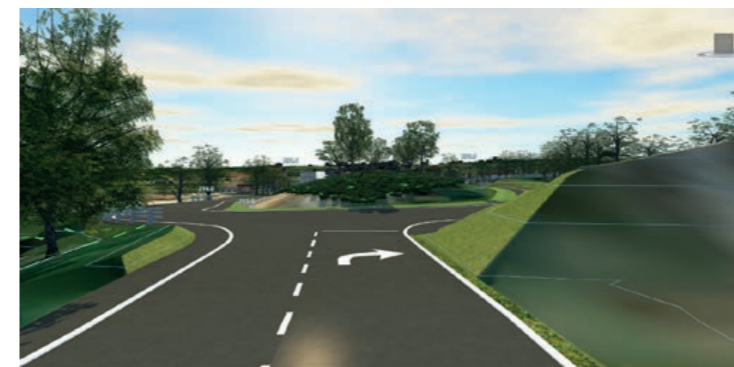
Vista del guidatore in approccio alla rotonda sud di progetto (modello BIM); da notare l'isola a duna verde.
