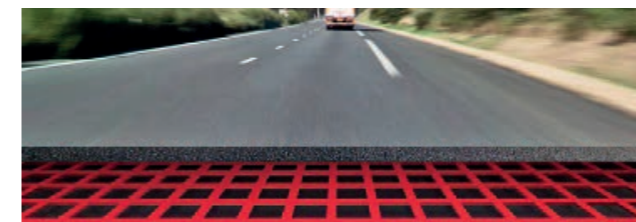
La rete di rinforzo alle azioni tangenziali, specie sulle rotatorie, permette una maggiore durabilità della pavimentazione senza compromettere il rifacimento del tappetino.
