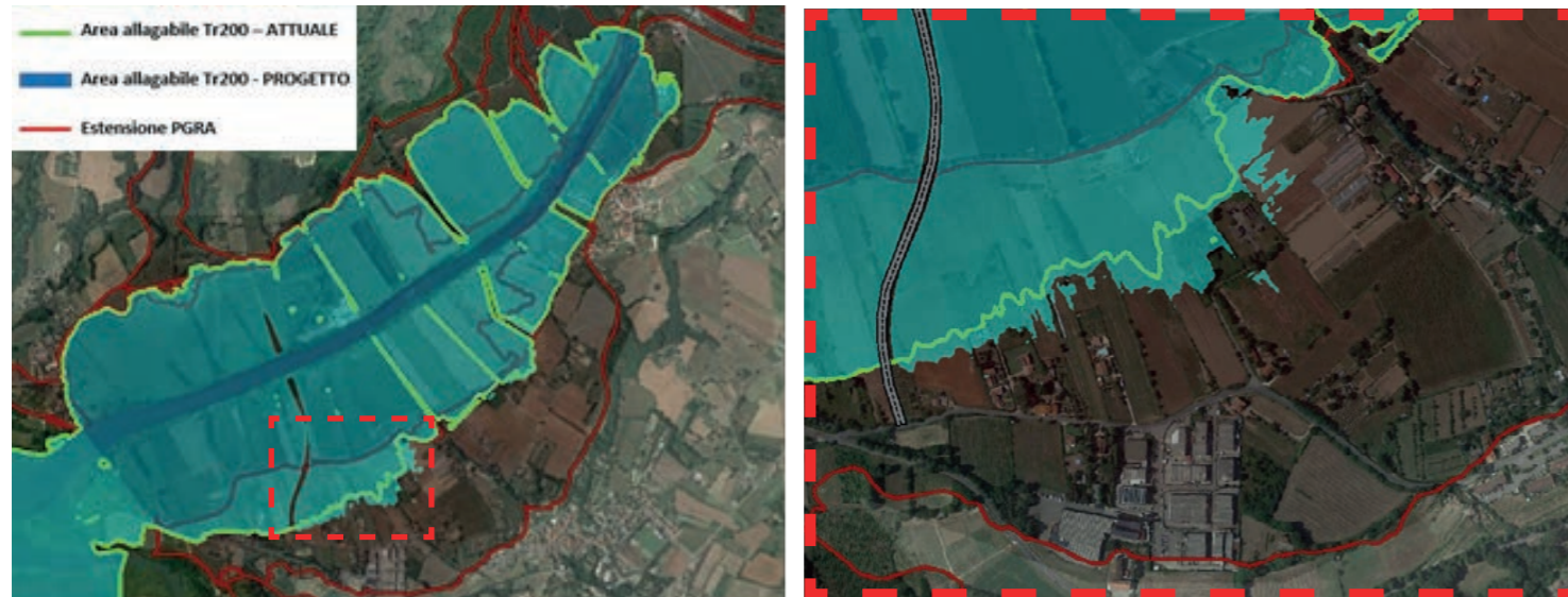
Aree allagabili nella configurazione di progetto, confrontata con le aree allagabili dello stato attuale e con il PGRA
