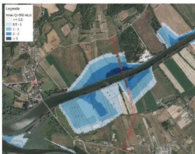
Figura 9 - Involuppo dei tiranti massimi per evento ordinario con portata di picco pari a 500 mc/s (fonte: altro studio idraulico effettuato in zona limitrofa)
