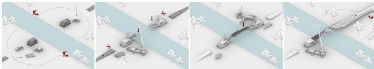
Figura 25: Schema delle fasi realizzative del ponte.
