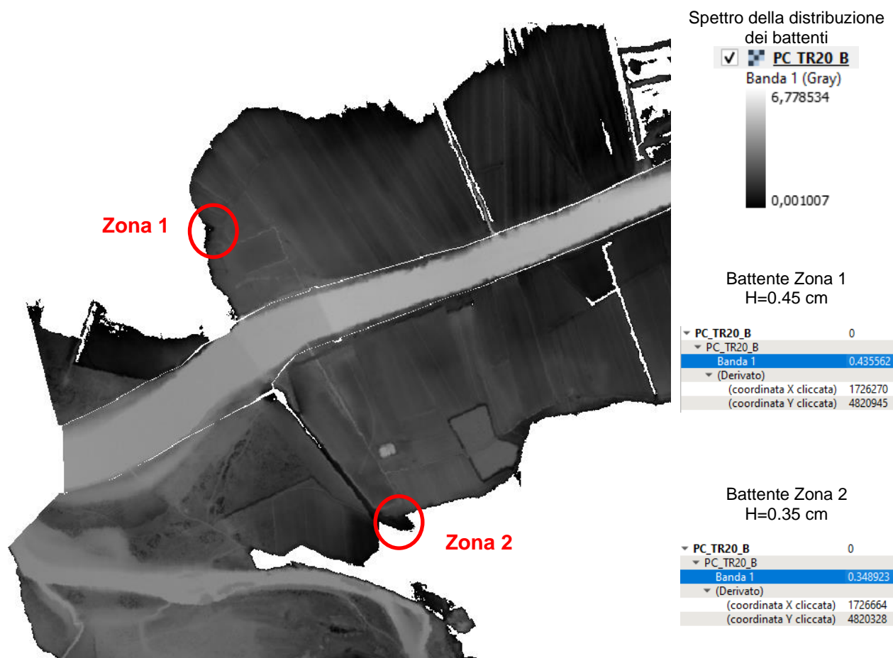
Fig. 26 – Distribuzione dei battenti (m) per eventi con T_R=20 anni - stato di progetto.
