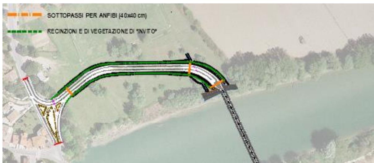
Fig. 42 – Posizionamento passaggio per specie anfibe nella viabilità in destra idrografica
