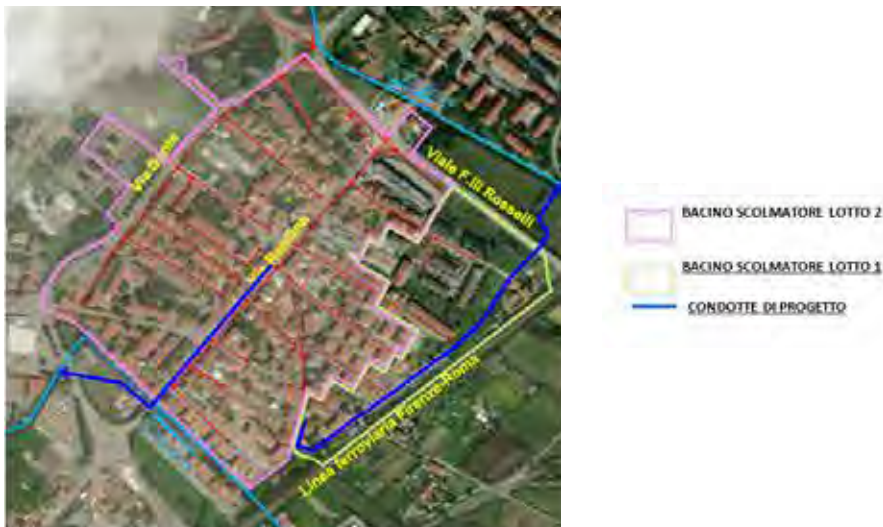
Figura 25: Arezzo, Via Romana. Inquadramento generale delle opere oggetto dei lavori Lotto 1 e Lotto 2
